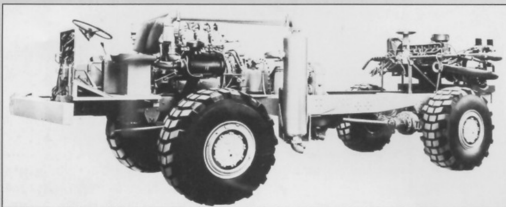
Das Chassis des KV 600 F mit Fahrmotor (links) und Pumpenantrieb.
