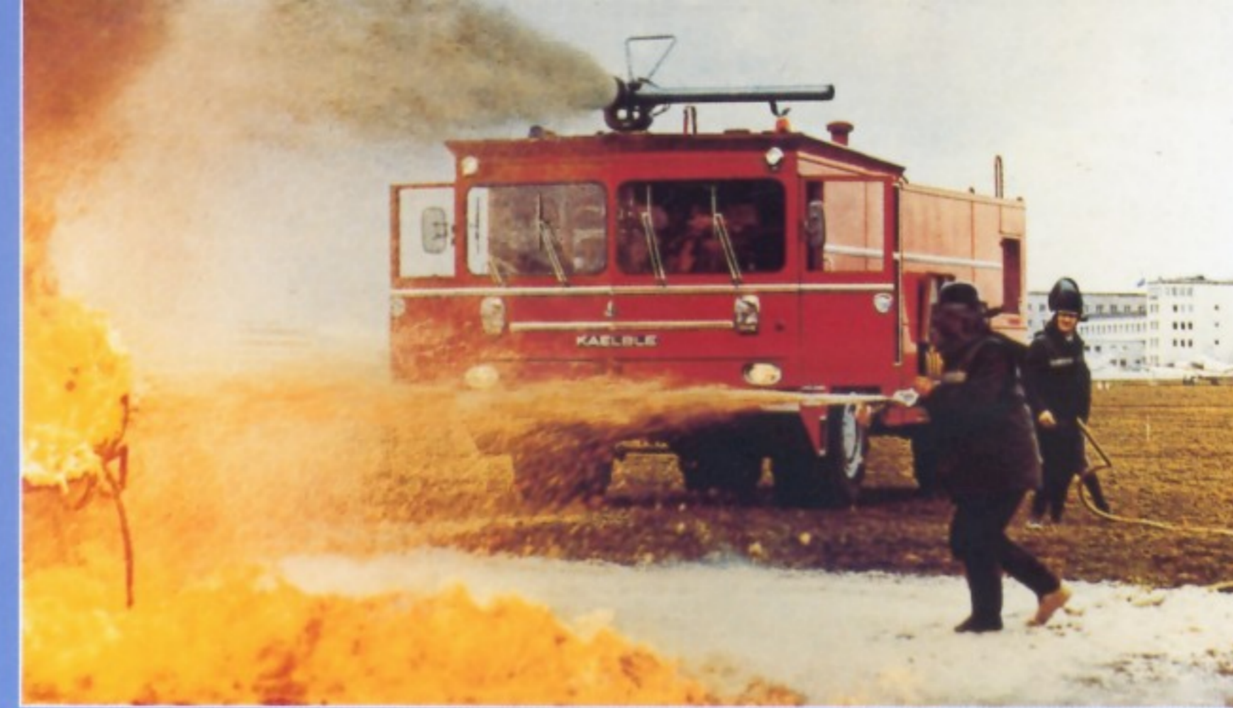
Löschübung: Die drei nach Stuttgart gelieferten FLF 66 auf KV 600 F-Chassis mit Saval-Kronenburg-Aufbauten blieben die einzigen ihrer Art.
