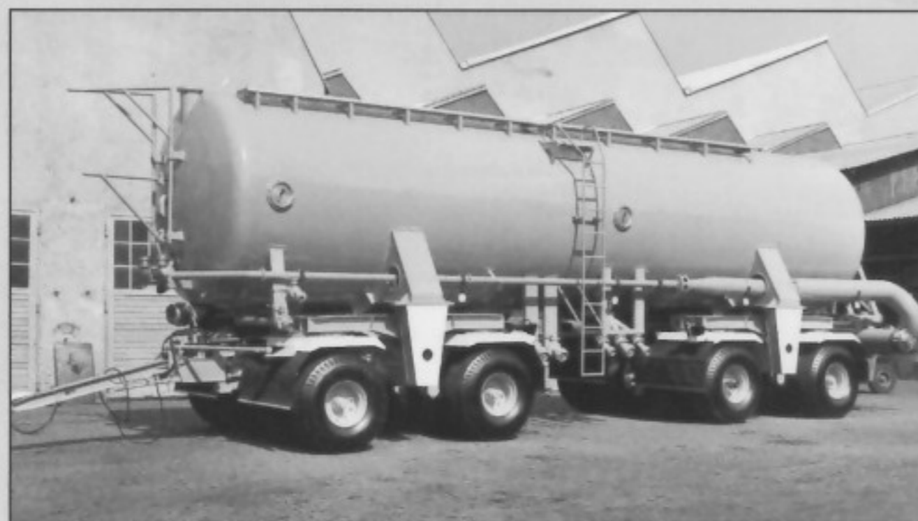
Der Landebahn-Beschäumungs-Anhänger FA-4 war ein Gemeinschaftsprodukt der Firmen Haller, Goldhofer und Schörling.
