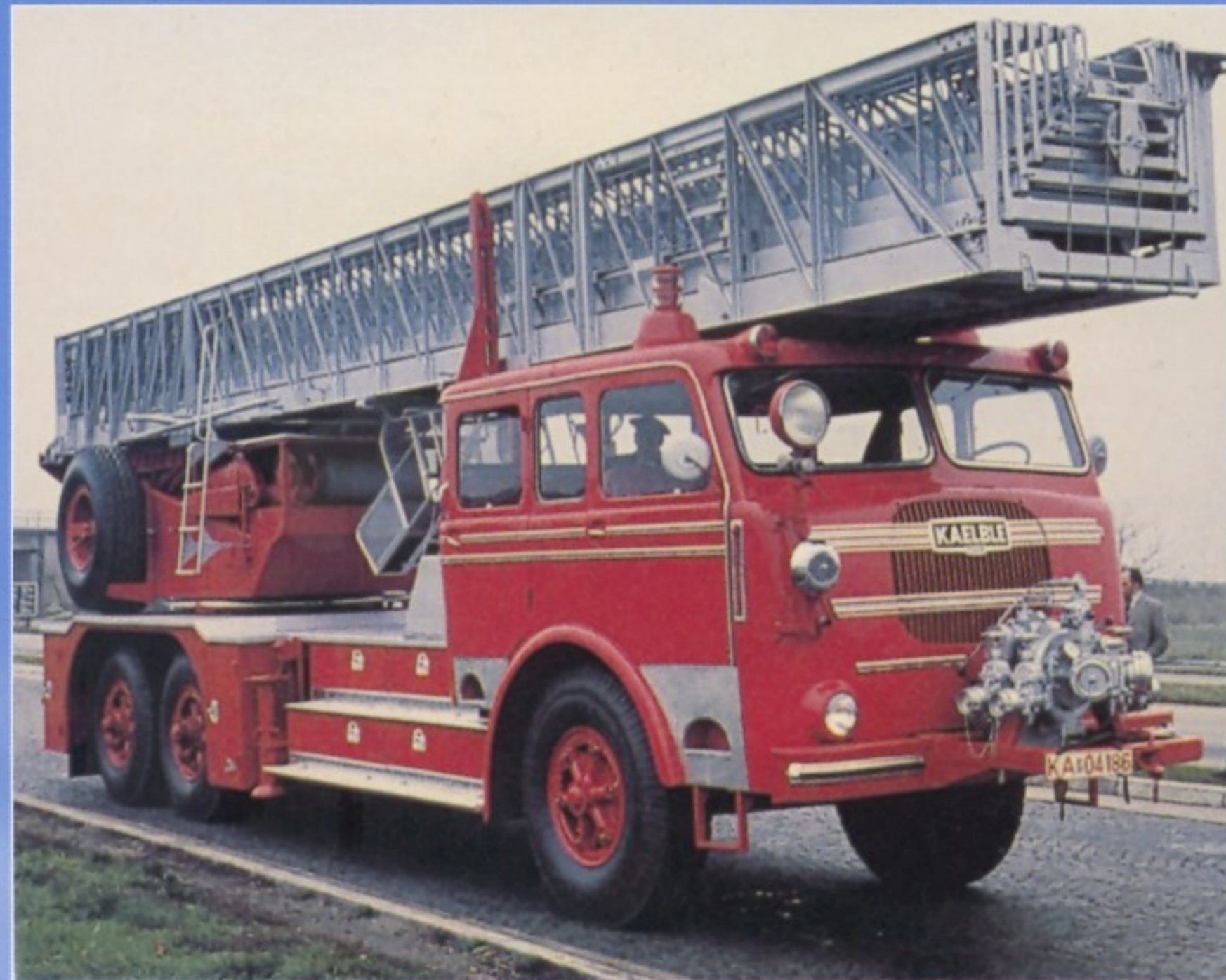
▲ Schwäbischer Massivbau: Für zierliche chinesische Feuerwehrleute war das Handling der 25 Tonnen wiegenden DL 60+2 auf dem KD 680 LF 6x4-Chassis sicherlich kein Kinderspiel.
