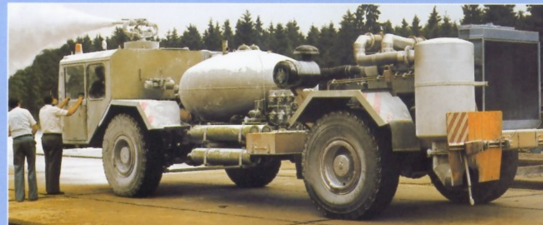
Röntgenblick: Bevor der Karosier Knapp ans Werk ging, erfolgten bereits erste Tests mit der von Saval-Kronenburg gelieferten Pulverlöschanlage.
