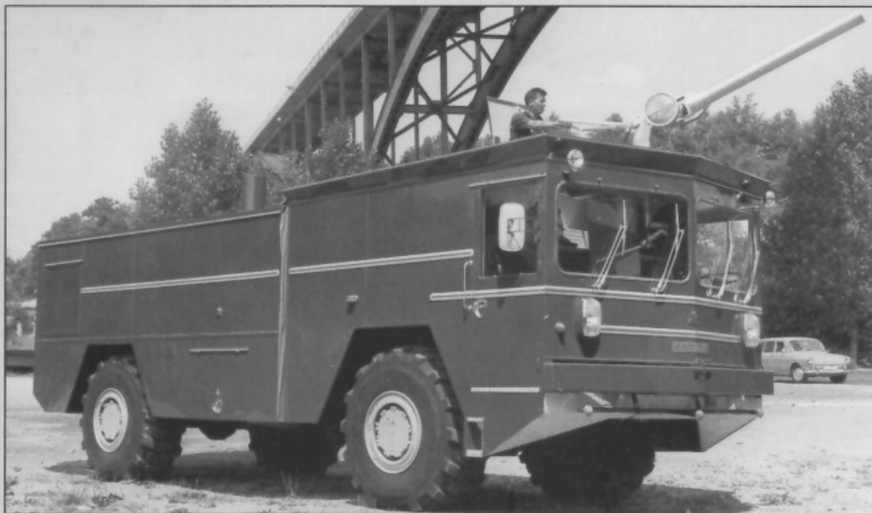
Mit Scheinwerfern des Mercedes/8-Pkw: Eines der beiden zuerst gelieferten KV 600 F-Großlöschfahrzeuge für den Flughafen Stuttgart im Lieferzustand.
