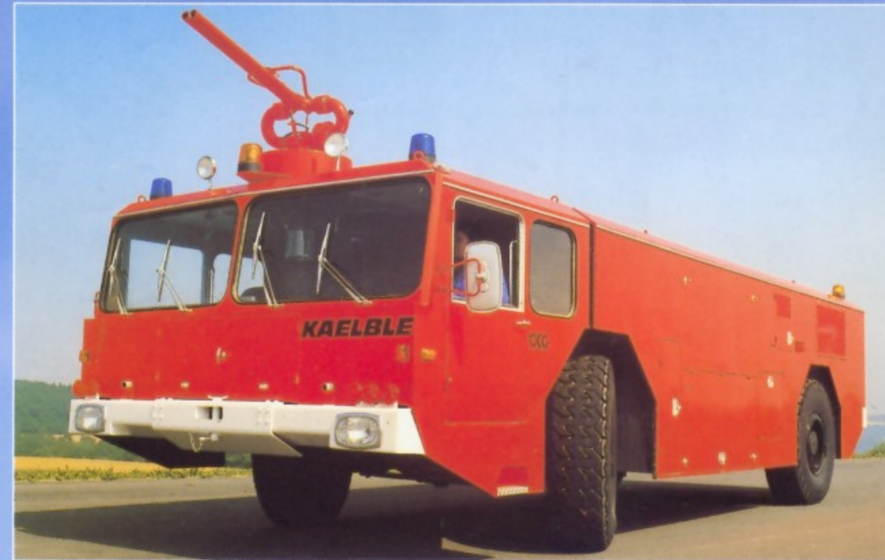
Flachmann: Das 1979 gebaute TroLF 3000 auf dem Chassis KVV 900 F 4x4 war Kaelbles letzter Praxis-Beitrag zum Thema Löschfahrzeug.
