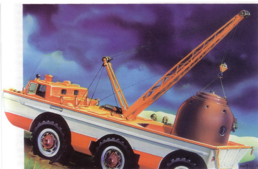
Установка и крепление спускаемого аппарата на ПЗ1-1: 1 – спускаемый аппарат; 2 – швартовочное кольцо; 3 – растяжка; 4 – ложе; 5 – кронштейн крепления ложа, 6 – переходник
