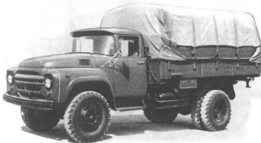
Рис. 65. Автомобиль ЗИЛ-130-76
