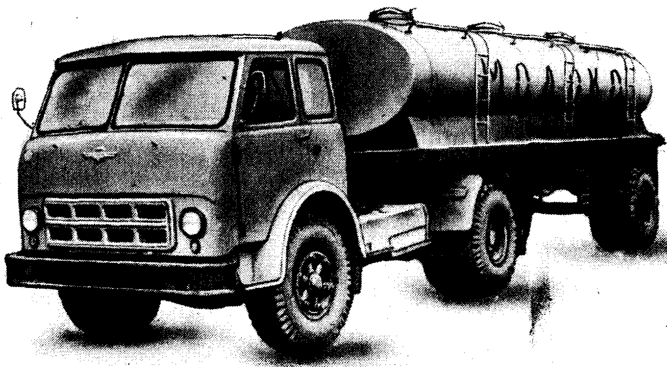
Полуприцеп-цистерна АЦПТ-11 с тягачом МАЗ-504А
