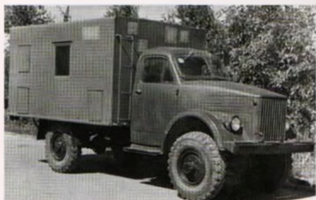
Изделие 926 (912) на шасси ГАЗ-633 с экранированным электрооборудованием обеспечивало работу передвижной станции
