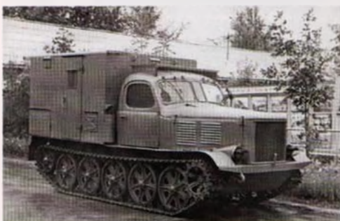
Каротажная лаборатория 927Б на базе ХТЗ-27А (АТ-Л – изделие 5А)
