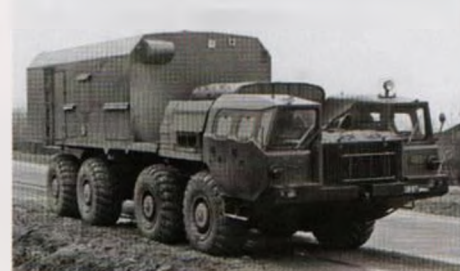
Изделие 2205 с погрузочной высотой 1780 мм
