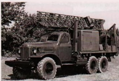
Телескопическая 24-метровая вышка модели 921 на полноприводном шасси ЗИЛ-157Е
