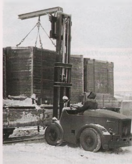
Погрузчик 4000М с блочной подвеской для деревянных нетарных контейнеров
