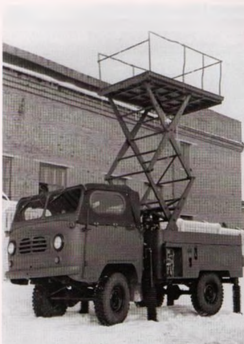
Подъемник А64 ножничного типа монтировался на шасси УАЗ-450Д (4x4)
