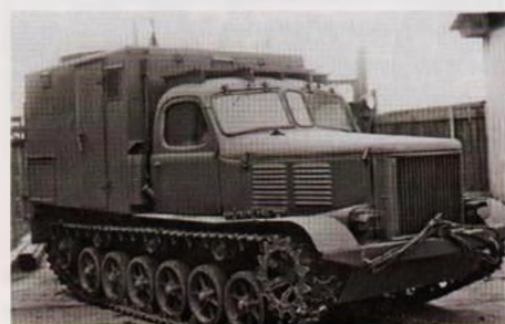
Утепленный металлический фургон 911 использовали в районах с холодным климатом
