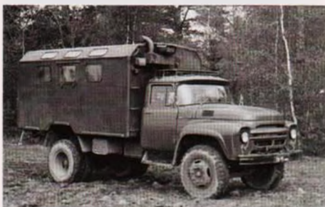
Кузов KM 130 середины 1960-х базировался на простой и надежной платформе ЗИЛ-130
