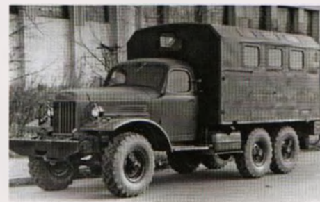
Кузов КМ 66У1Д широко использовался в Вооруженных Силах СССР и долгие годы находился в частях на консервации
