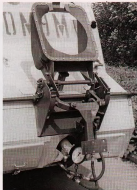
Опрокидыватель на мусоровозе 93М для 100-литровых мусорных контейнеров
