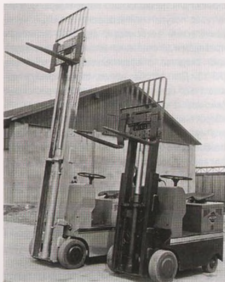
Погрузчики моделей 4004 и 4004А отличались высотой подъема вил
