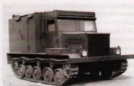
Кузов на шасси гусеничного тягача Я-12 отличался простотой и надежностью
