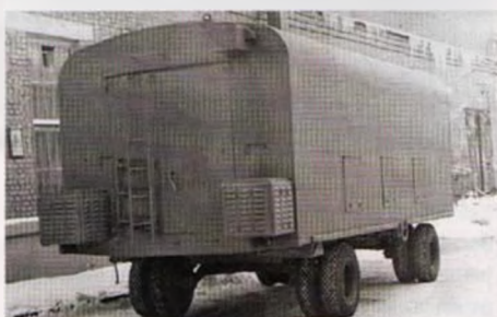
Фургон 770Е на шасси прицепа МАЗ-5224В грузоподъемностью 11 т
