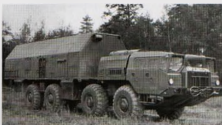
Изделие 2213 грузоподъемностью 12 700 кг легко двигалось по пересеченной местности
