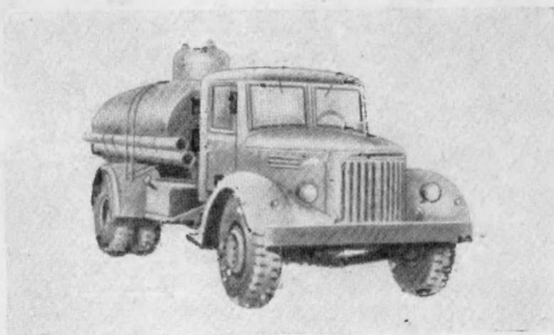
Автомобиль-цистерна для перевозки жидкого топлива выпускается заводом «Стройформашин» на шасси автомобиля МАЗ-200.
