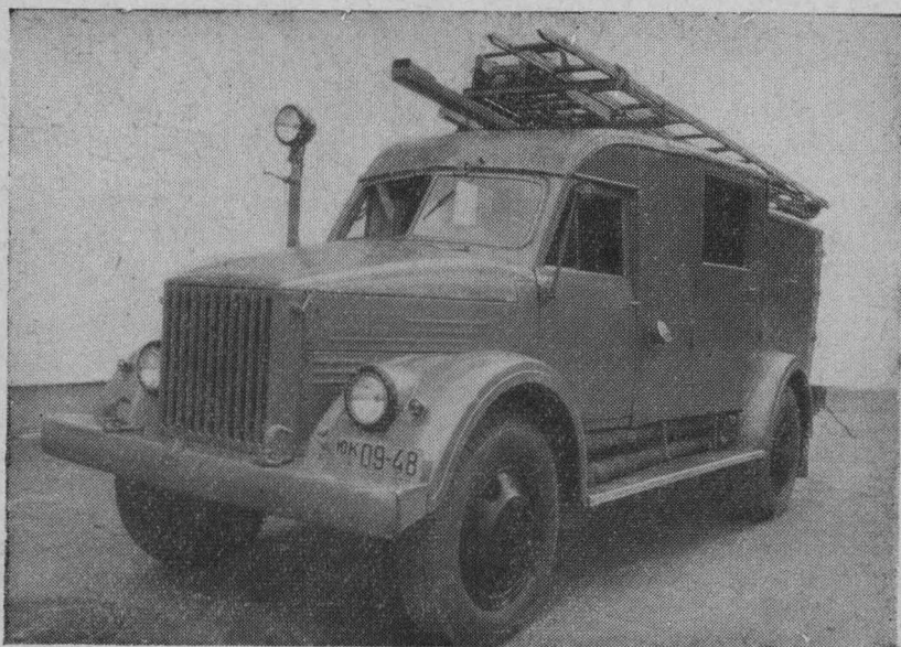
Рис. 1. Общий вид автонасоса АН-25 (51)-12.
