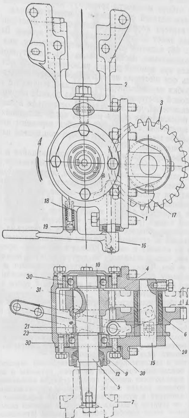
Рис. 68. Коробка отбора мощности (в разрезе). Название деталей см. в подписи к рис. 67.
