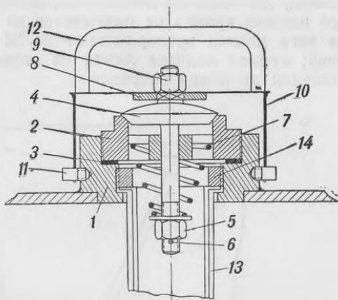
Шток клапана проходит через центральное отверстие гнезда клапана, служащее для него направляющей.
