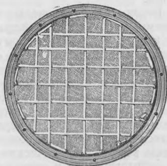
Рис. 58. Фильтрующая коробка с сеткой и полотном.
