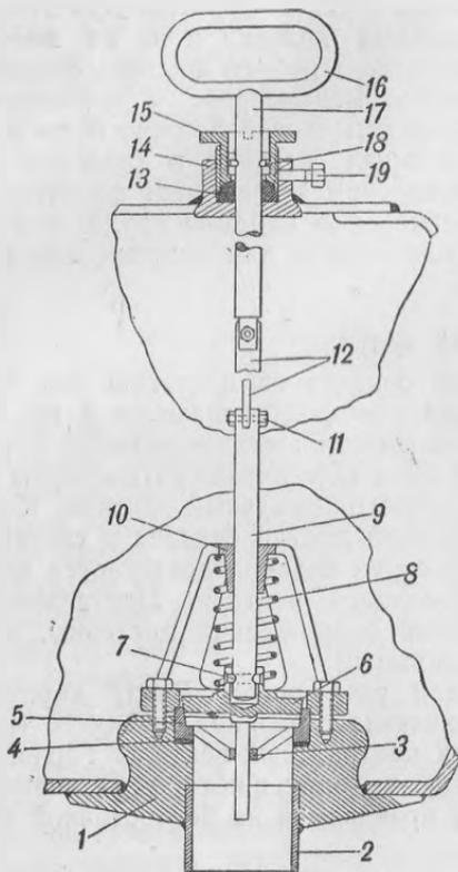
Рис. 59. Схема центрального вентиля.
