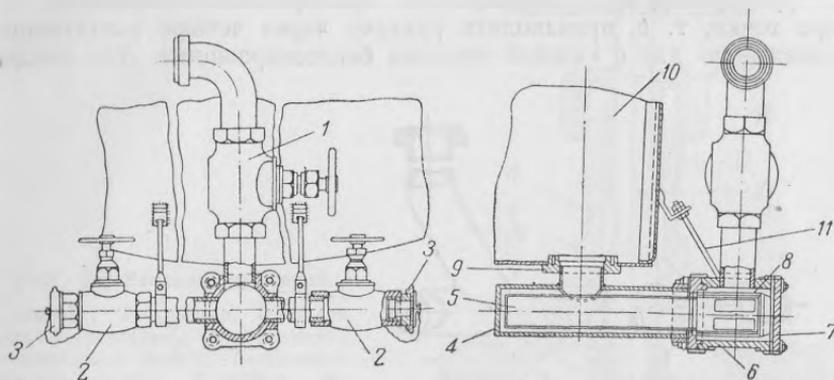
Рис. 61. Спускной трубопровод.
