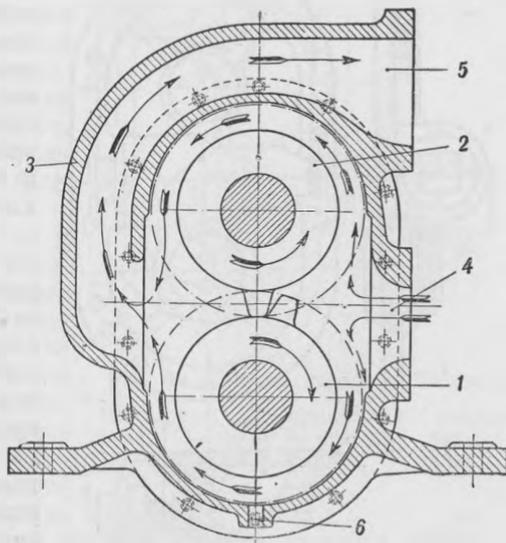
Рис. 72. Насос ШВ-200 (разрез) (путь горючего показан стрелками).
