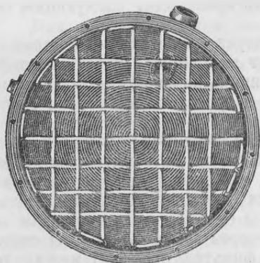
Рис. 57. Верхняя часть корпуса фильтра с предохранительной сеткой.
