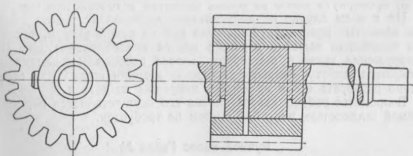
Рис. 75. Ведущая шестерня насоса с валом.
