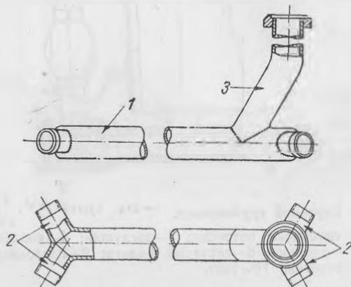
Рис. 62. Схема раздаточного трубопровода.
