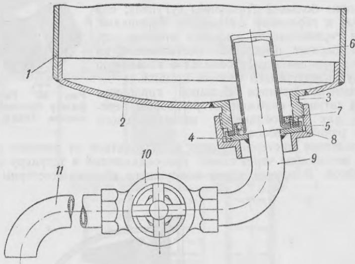
Рис. 50. Отстойник с трубопроводом.
