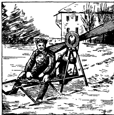
Фиг. 1. Аэросани конструкции Ю. Меллера, построенные в 1910 г.
