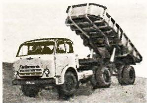
ми телескопического типа. Задняя часть кузова несколько приподнята вверх, что исключает потери груза при транспортировке. Такой автопоезд развивает скорость до 75 км/час и расходует 45 литров топлива на 100 км пути.
