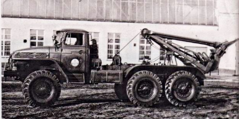
Эвакуационный тягач КЭТ-Л на шасси «Урал» выпускали на «Прогрессе» непродолжительное время в конце 1960-х
