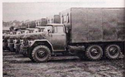
Партия из 6 штабных автомобилей на шасси ЗИЛ-131 с кузовами переменного объема, т. е. с раздвижными боковинами. В войсках подобные машины назывались «бабочками»
