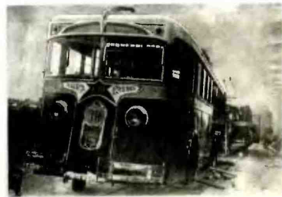
Опытный образец 3-осного ЛК-3 (длина — 12 м, ширина — 2,3 м, число мест — 85). На лобовой стороне знаменательная надпись «Подарок XVII съезду ВКП(б)».
