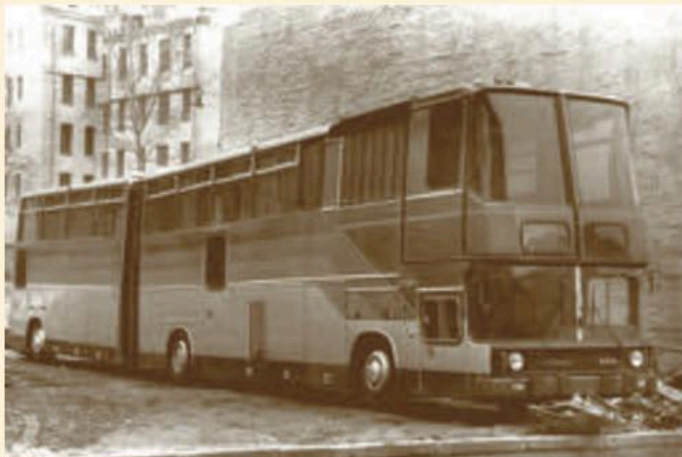
Икарус 1983 - 1985 Модель «695». Высокопольный сочлененный венгерский монстр стал главным экспонатом Венгерской выставки в Москве в 1985 году, однако в серию не пошел.
