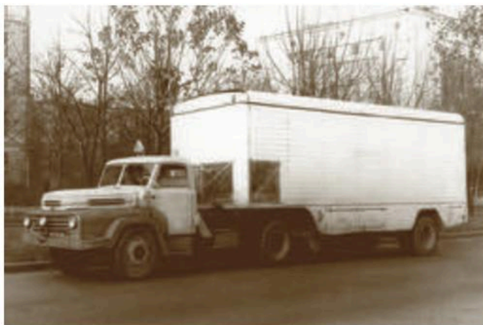
Чепель Д-450 1957 - 1963. Седельный тягач "Чепель" с полуприцепом-рефрижератором на Ленинском проспекте в Москве. Холодильники "Икарус" эксплуатировались у нас наряду со Шкодами, Прагами и Австро-Фиатами.
