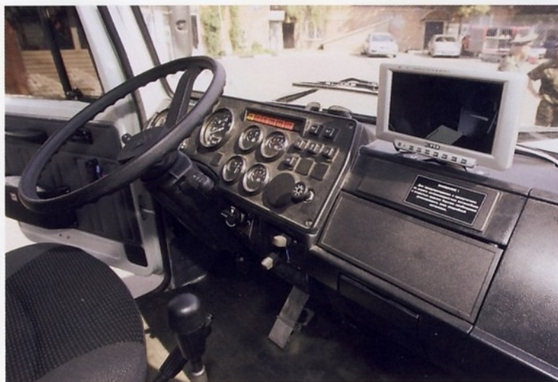
В кабине водителя установлен монитор наблюдения за происходящим в салоне
